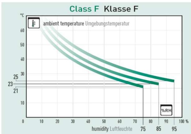
Limits of relative humidity of the ambient climate in relation to the ambient temperature. Grenzen der relativen Luftfeuchte des Kondensators in Abhängigkeit von der Umgebungstemperatur.
